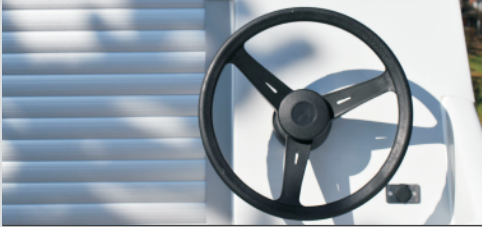
Steuerrad „Basic“ inkl. Steueranlage (Teleflex)
