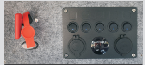
Schalttafel in der Kajüte 5x Wippschalter, 2x USB, 1x 12V
