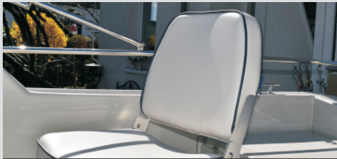
Fahrer-/Beifahrersitz „Pro“ höhenverstellbar, klappbar, gepolstert
